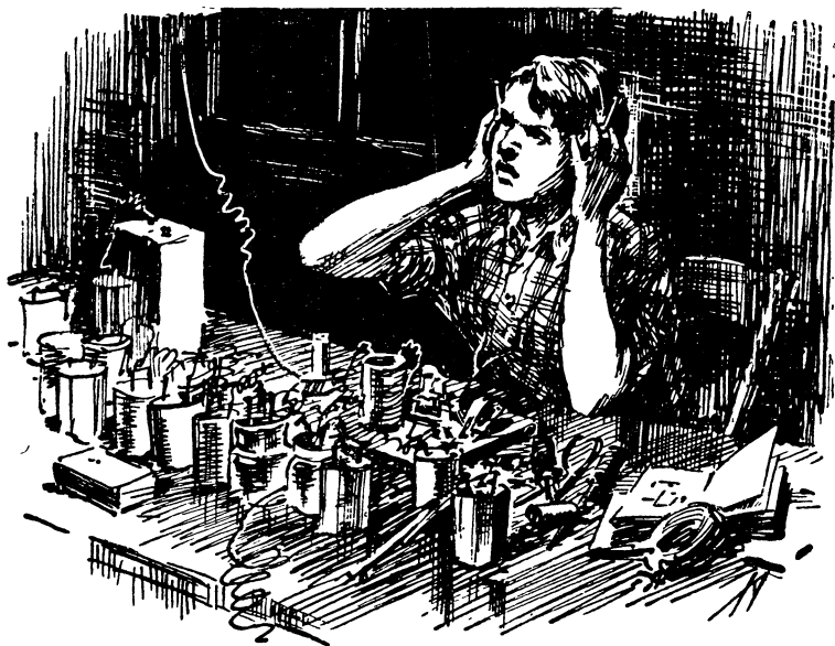
Появилась батарея элементов в чайных стаканах.
